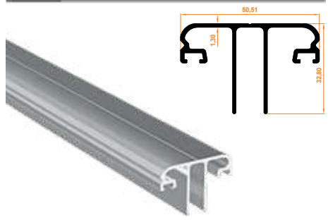
429 Cam Çitası Profili Glass Strip Profile
