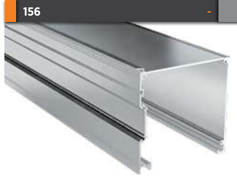
156 - Üst Kasa Profil Top Case Profile Paket İçi Adet Quantity Per Package 1 Gramajı Weight 3,449 kg/m
