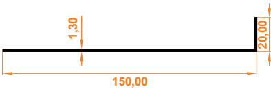
20x150 Köşebent 20x150 Angle Bracket
