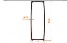
Ahşap Jaluzi Perde Etek Profil Venetian Blind Bottomrail Profile Paket İçi Adet Quantity Per Package 6 Gramajı Weight 0,253 kg/m
